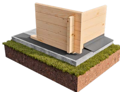
Фундамент в виде сплошной плиты.
