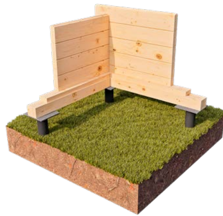
Свайный фундамент с деревянным обвязочным ростверком.
