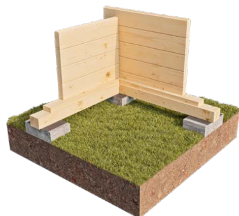
Фундамент из полнотелых цементно-песчаных блоков.
